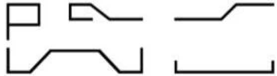
Рис. 5 Формы изгиба арматуры
