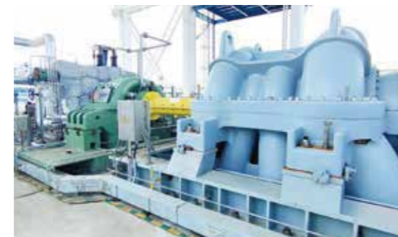
Одновалный многоступенчатый центробежный компрессор
