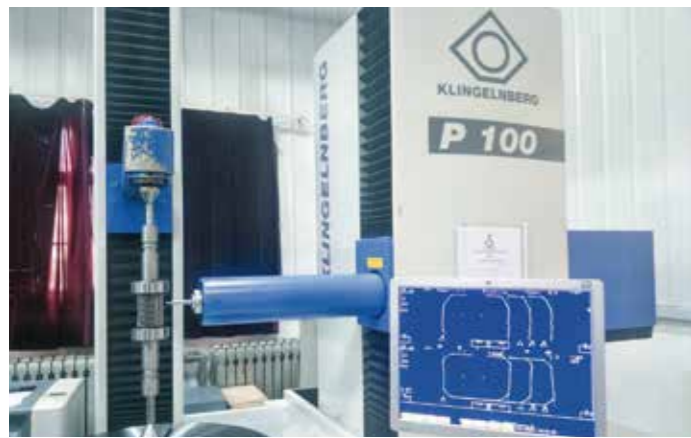
Контроль вала редуктора
